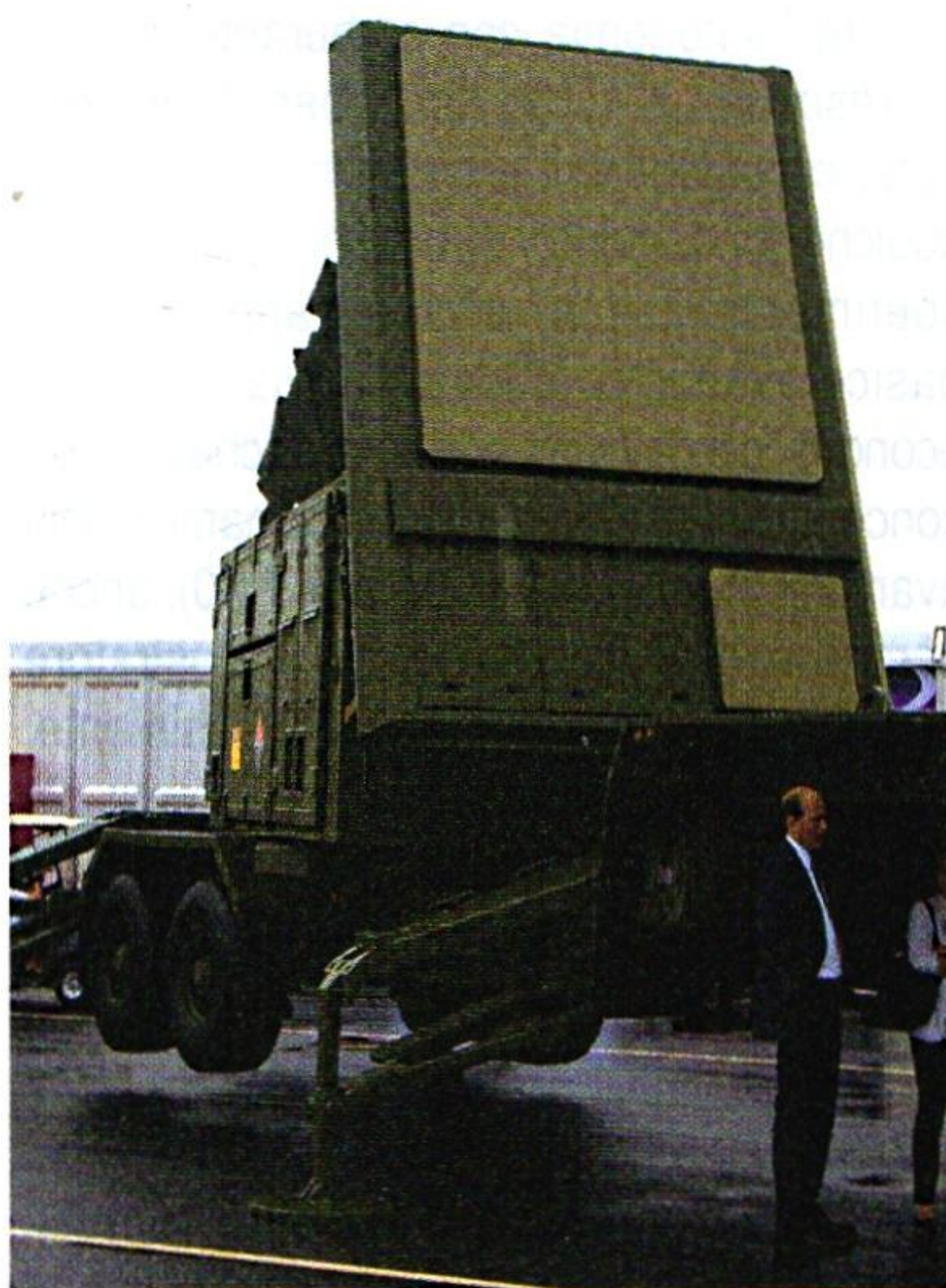
Sopra: il radar multifunzionale tipo AESA (dotato di circuiti al nitruro di gallio) per il sistema PATRIOT presentato dalla Raytheon. Sotto: la nuova arma laser per la difesa contro UAV, razzi e bombe da mortaio mostrata per la prima volta da MBDA. Questo "Laser effector" è installabile su piattaforme terrestri o navali e assicura una copertura su 360° anche contro bersagli multipli.
