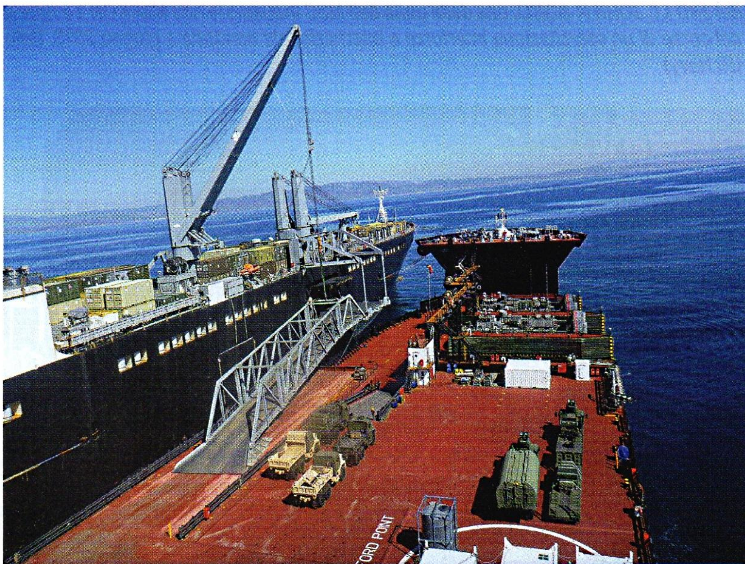
Movimento di veicoli ruotati fra il DAHL (T-AKR 313) e il MONTFORD POINT (T-ESD 1, su cui sono imbarcati 2 mezzi tipo LCAC) durante l'esercitazione PACIFIC HORIZON 2015: la gru che sorregge la rampa di collegamento può essere utilizzata anche per lo sbarco dei container visibili sul DAHL. (foto: US Navy)
