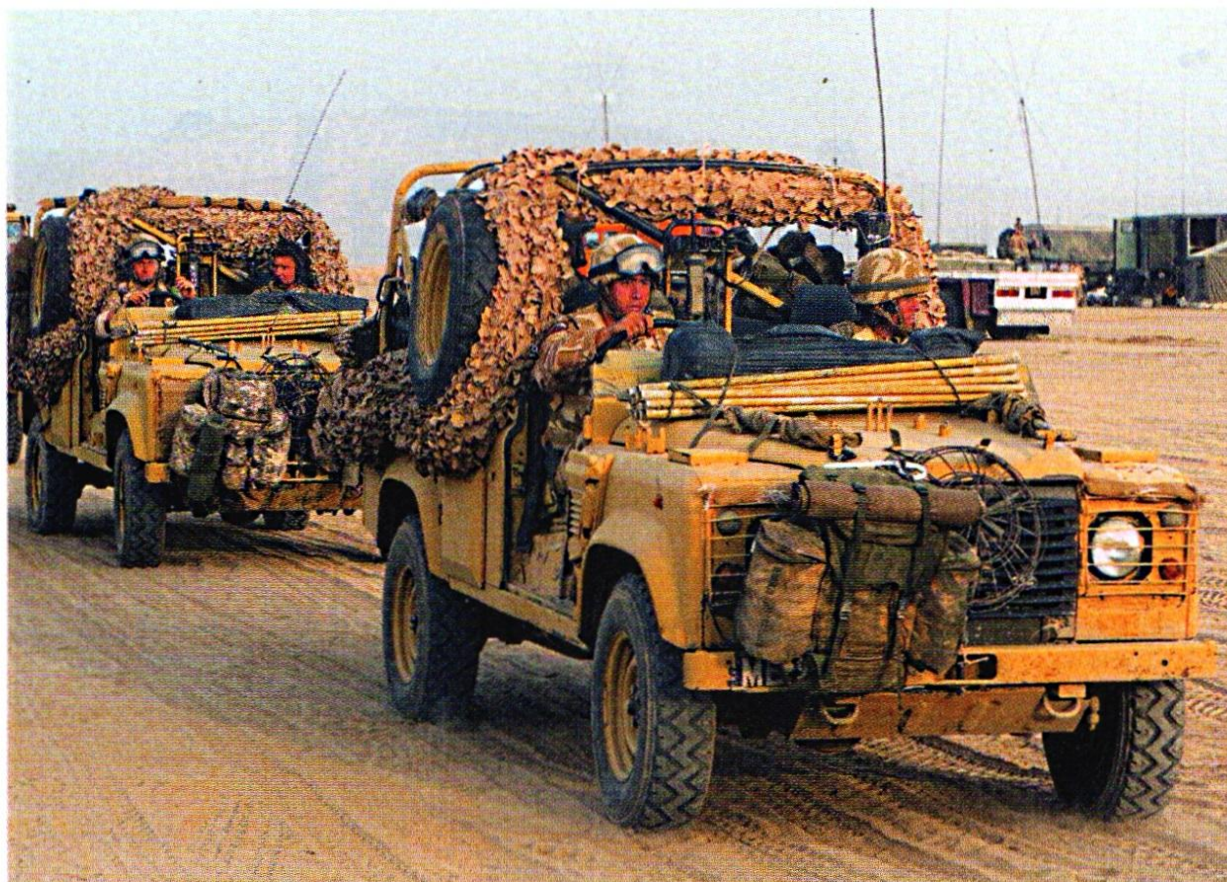
Due WOLF 110 WMIK in pattuglia nei dintorni della città irachena di Bassora, all'epoca dell'Operazione TELIC. Sono evidenti gli speciali pneumatici per terreni sabbiosi.
