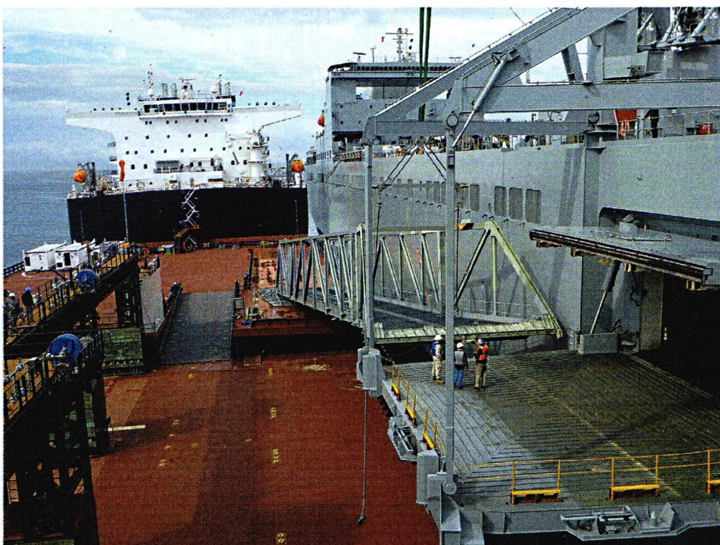
In primo piano, la rampa di collegamento fra il portellone di un'unità tipo T-AKE e il mission stowage deck di una tipo T-ESD: la rampa più piccola, al centro, serve per il transito dei veicoli dal suddetto deck all'area di parcheggio degli LCAC. (foto: US Navy)
