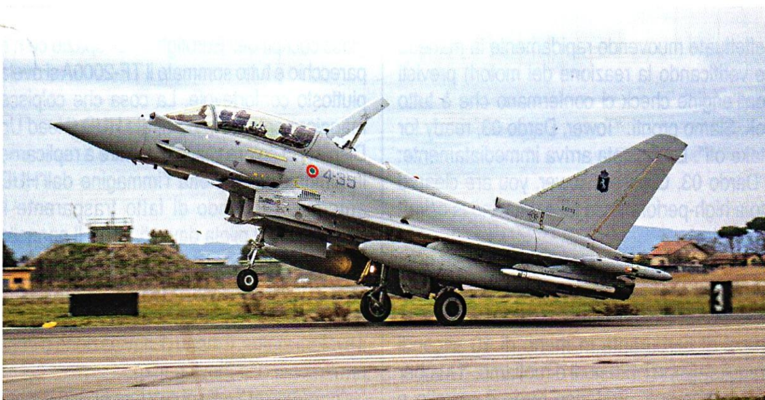
Sopra: l'Eurofighter matricola MM55132/"4-35", ripreso subito dopo il touch-down, esegue una frenata aerodinamica coadiuvata dal grande aerofreno dorsale. (Foto Iolanda Frisina). Sotto: un caratteristico "selfie" dell'Autore nel backseat del TYPHOON biposto durante l'impressionante salita prevista dall'high-performance take-off, una procedura utilizzata durante i decolli su allarme delle cellule in QRA (Quick Reaction Alert).
