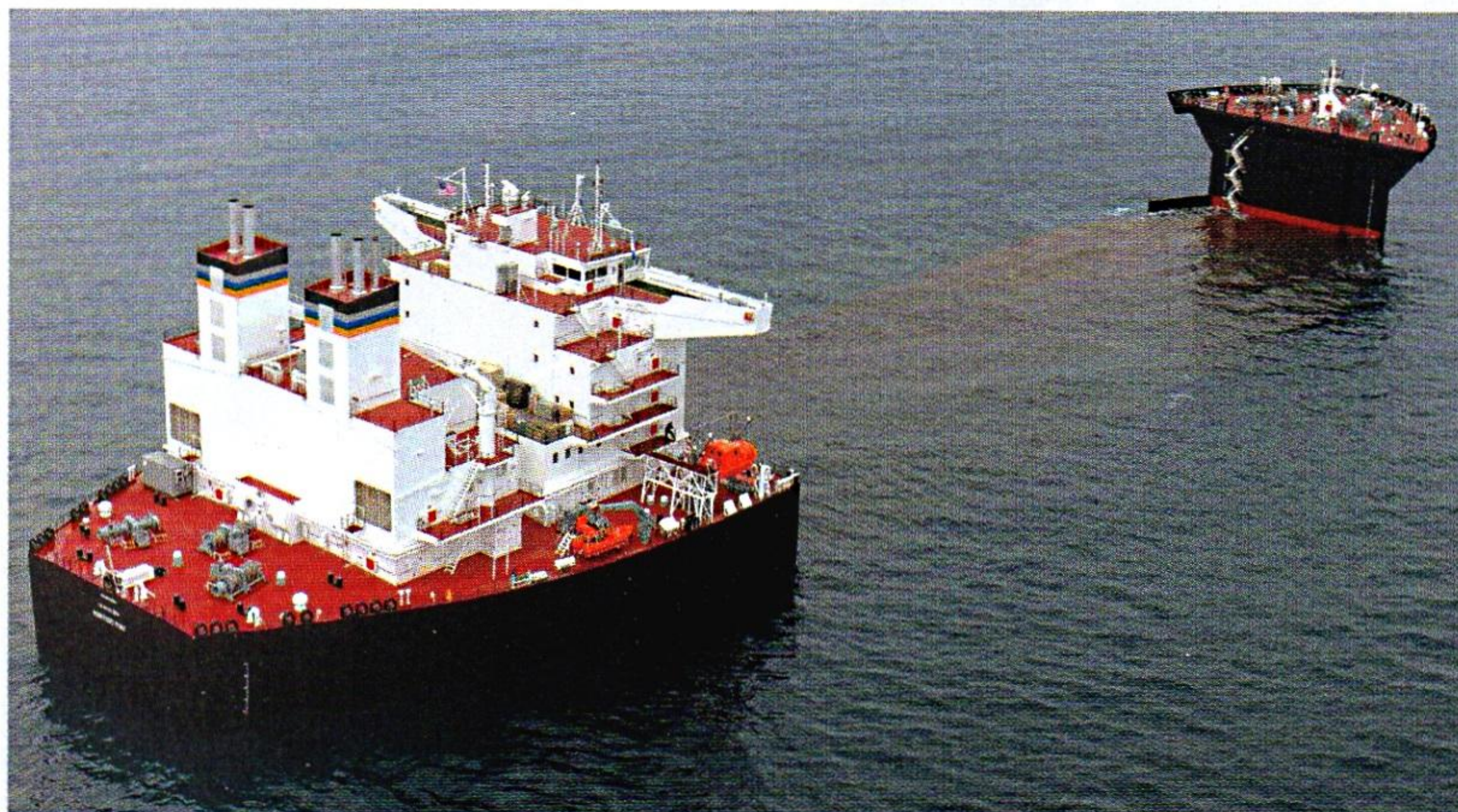
Il MONTFORD POINT dimostra le sue qualità FLO/FLO, immergendo la zona centrale dello scafo fino a un livello superiore a quello normalmente necessario per le operazioni con i mezzi anfibi tipi LCAC. (foto: NASSCO)
