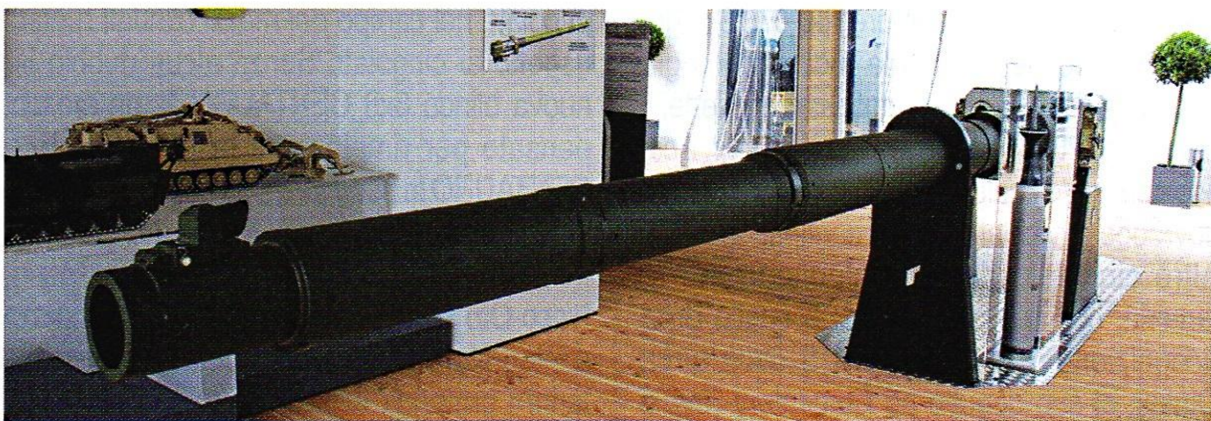
Il nuovo cannone Rheinmetall da 130 mm L51 costituisce una delle prime conseguenze pratiche derivanti dall'apparizione del nuovo carro T-14 ARMATA. (foto: Eugenio Po)
