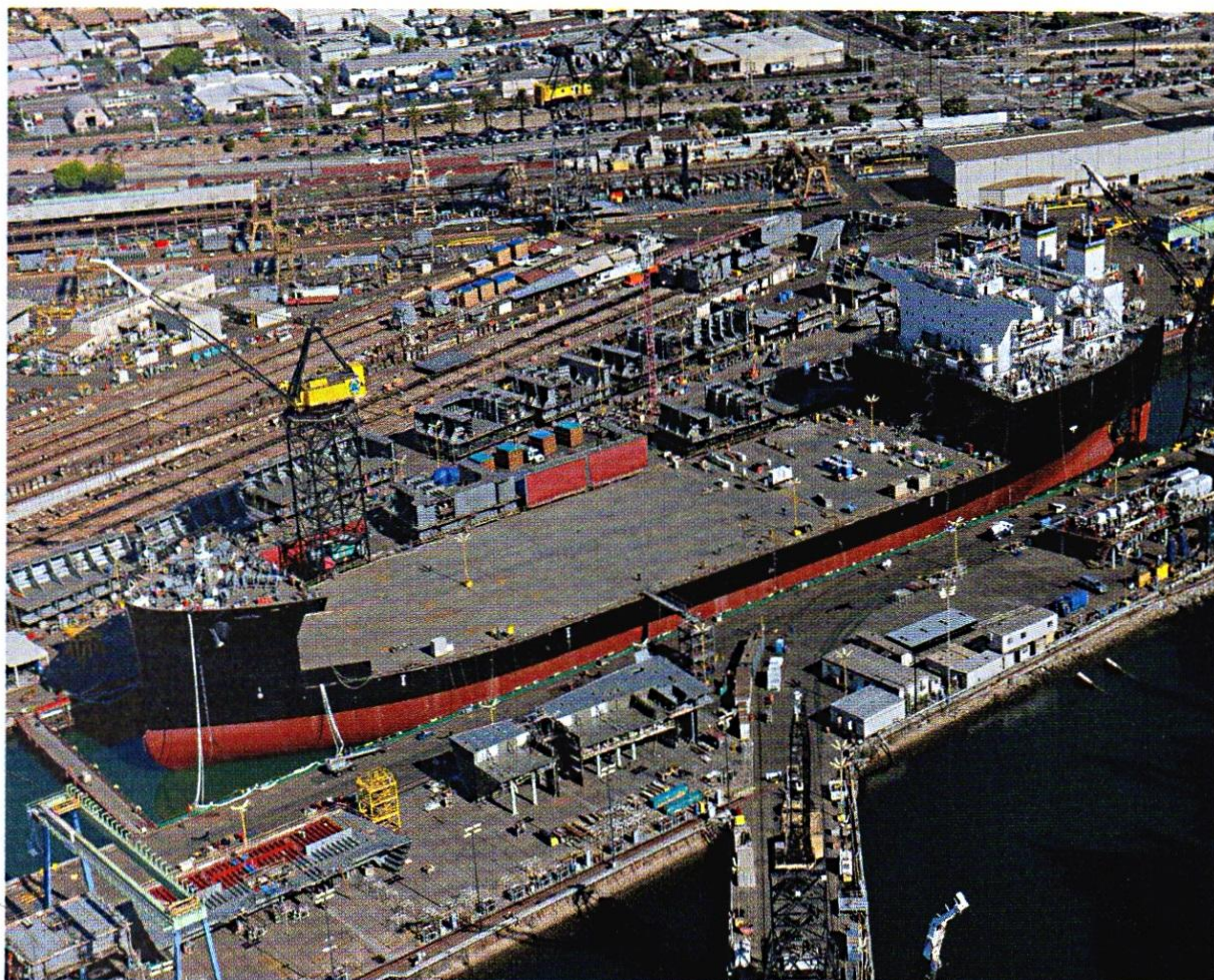
Il MONTFORD POINT poco dopo il varo, avvenuto presso i cantieri NASSCO di San Diego il 13 novembre 2012: ben visibile l'ampia superficie su cui sarà installato il mission stowage deck. (foto: NASSCO)
