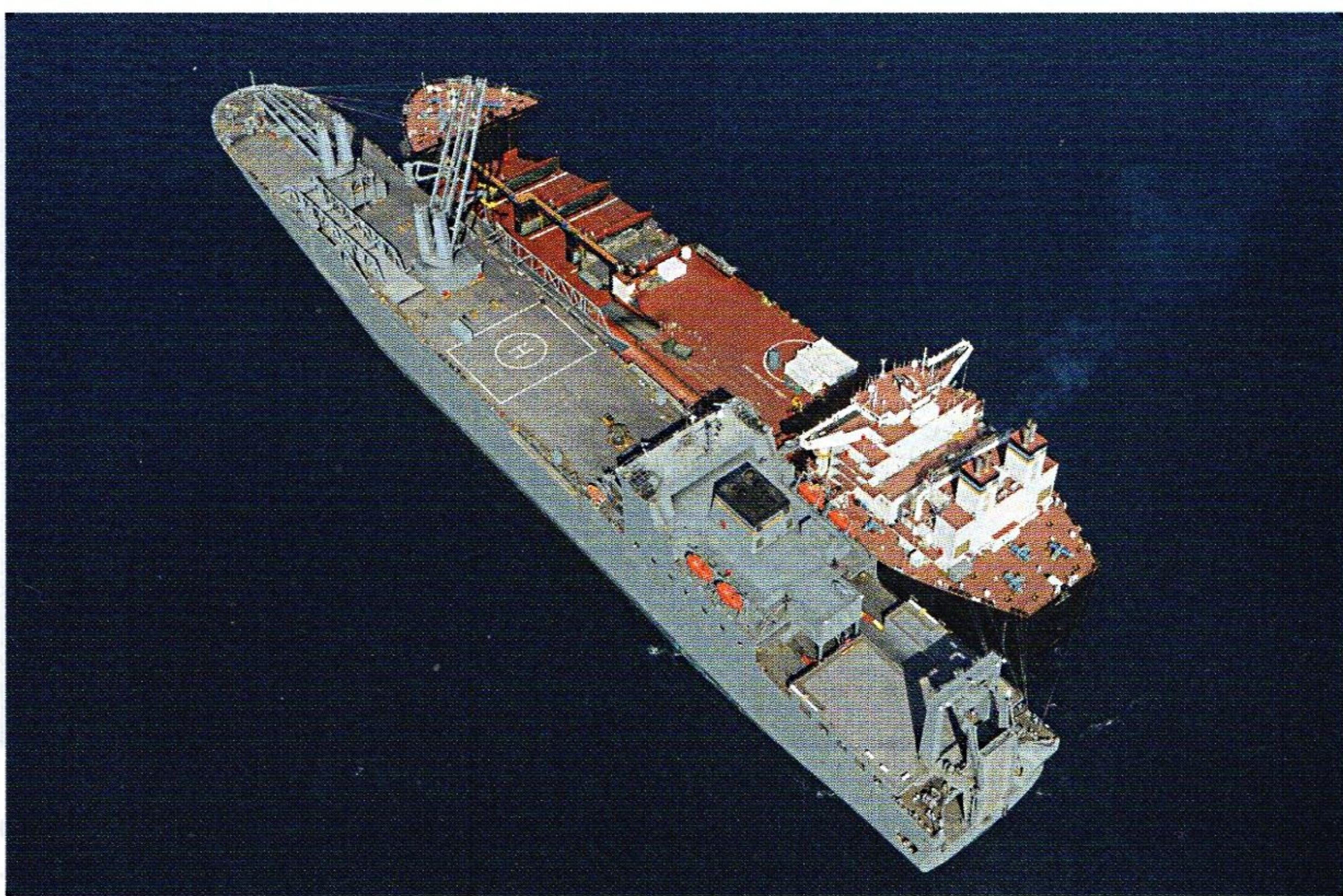
Prove di affiancamento fra il MONTFORD POINT e le unità del Military Sealift Command, in questo caso il BOB HOPE: evidente, sulla prima unità, la configurazione delle tughe poppiere. (foto: US Navy)
