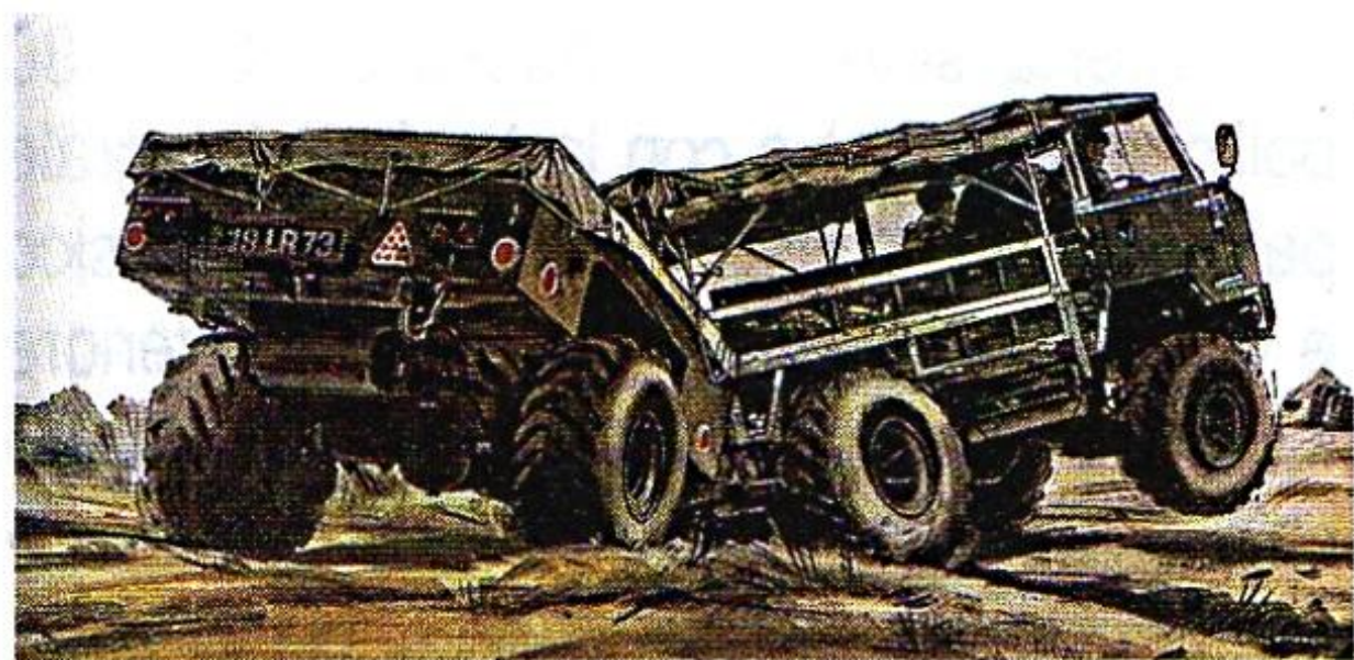
Sopra: vista interna della trasmissione della LAND ROVER Series IIA. Sotto: un FC-101 con il rimorchio a ruote motrici.
