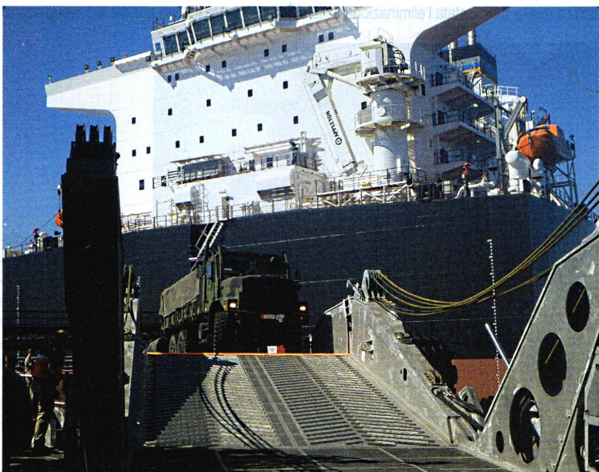
Un autocarro pesante dei Marines imbocca la rampa snodabile utilizzata per la movimentazione di veicoli fra le unità T-ESD e quelle tipo T-EPF, in questo caso il MILLINOCKET. Gli oblò rettangolari visibili sotto la plancia del MONTFORD POINT corrispondono ai locali dell'equipaggio. (foto: US Navy)
