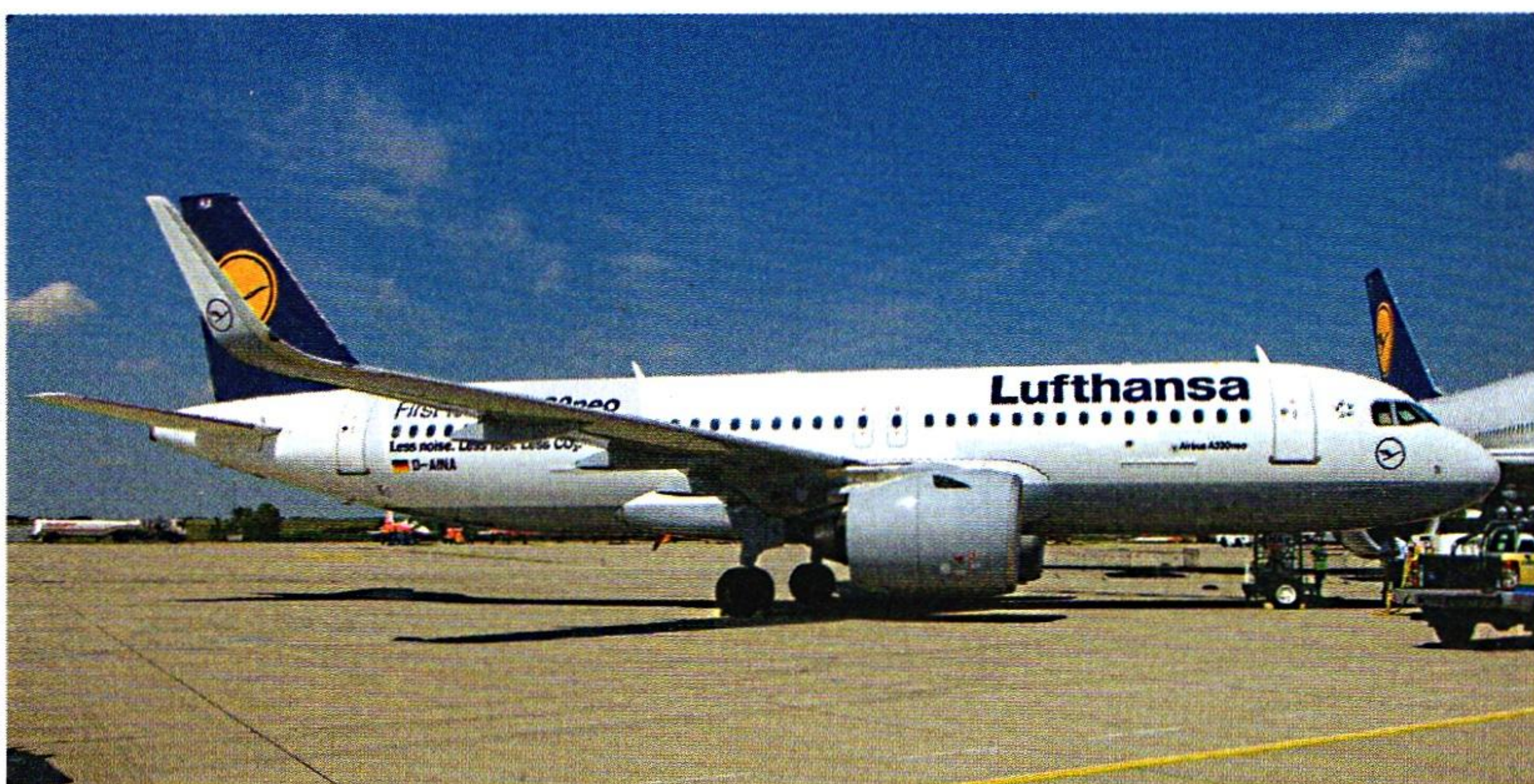
Airbus era ovviamente la protagonista assoluta del salone berlinese, dove ha portato uno dei suoi primissimi A320neo di nuova generazione, con turbofan "geared" PW1100G della Pratt & Whitney, entrati in servizio con la Lufthansa.
