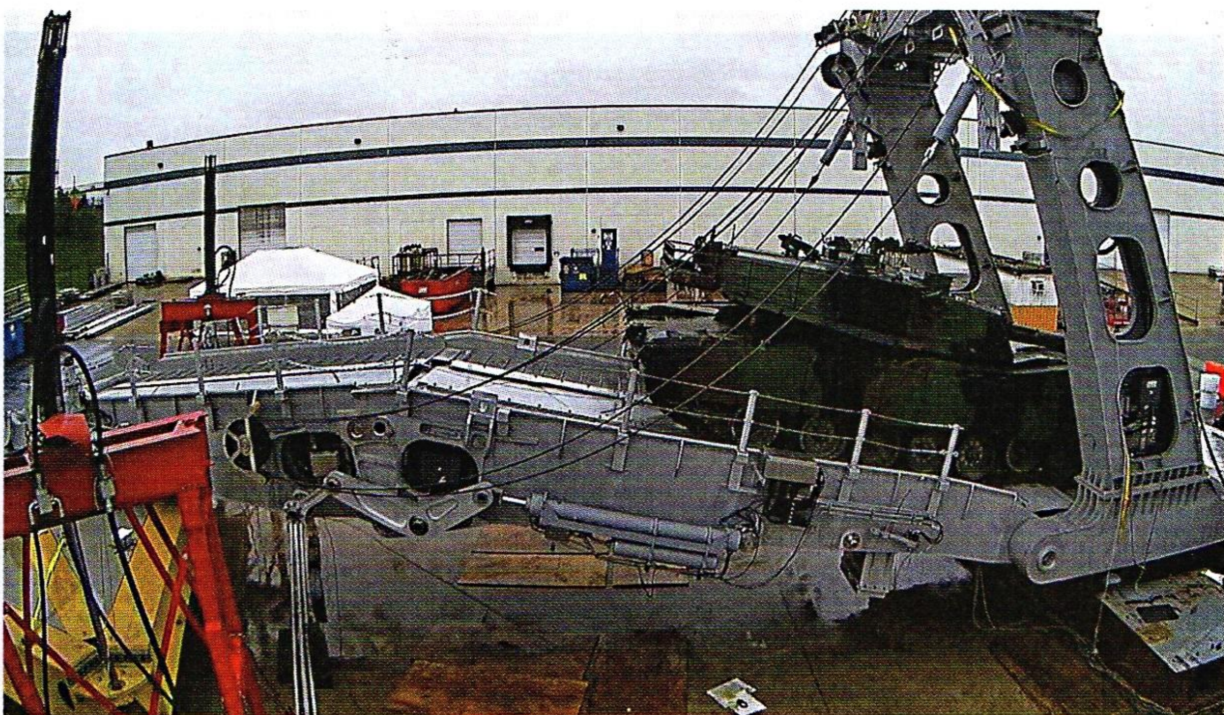
Un carro da combattimento M-1A1 dei Marines in transito sulla rampa snodabile costruita nell'ambito del progetto Interface Ramp Technologies, finalizzato alla realizzazione di sistemi per facilitare il trasferimento di mezzi ruotati e cingolati fra il naviglio delle nuove categorie ESD e EPT. (foto: US Navy)
