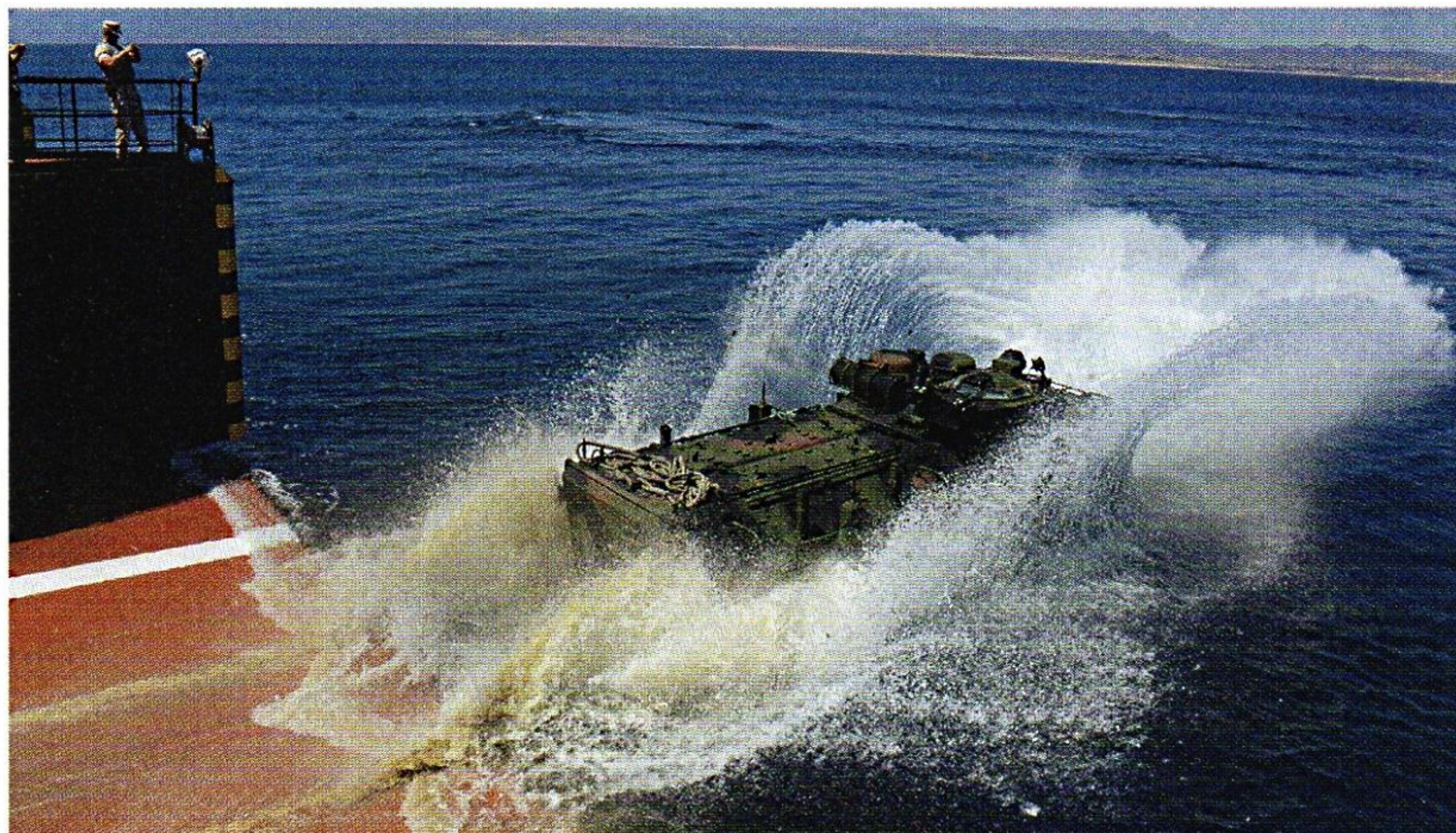
Un cingolato d'assalto anfibio AAV-7A1 dei Marines in partenza da un'unità tipo ESD, dimostratasi così idonea a far operare anche mezzi di questo tipo nell'ambito delle evoluzioni marinaresche attuabili nel Seabasing. (foto: US Navy)
