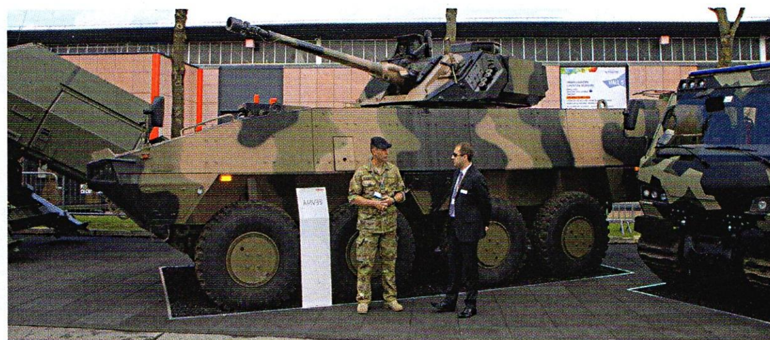
Un altro dei partecipanti al programma australiano Land 400 Phase 2 (notare sempre la mimetica dell'Esercito Australiano): si tratta dell'AMV-35, un Patria AMV dotato di torretta BAE Systems Hägglunds armata di mitragliera da 35 mm. (foto: Eugenio Po)
