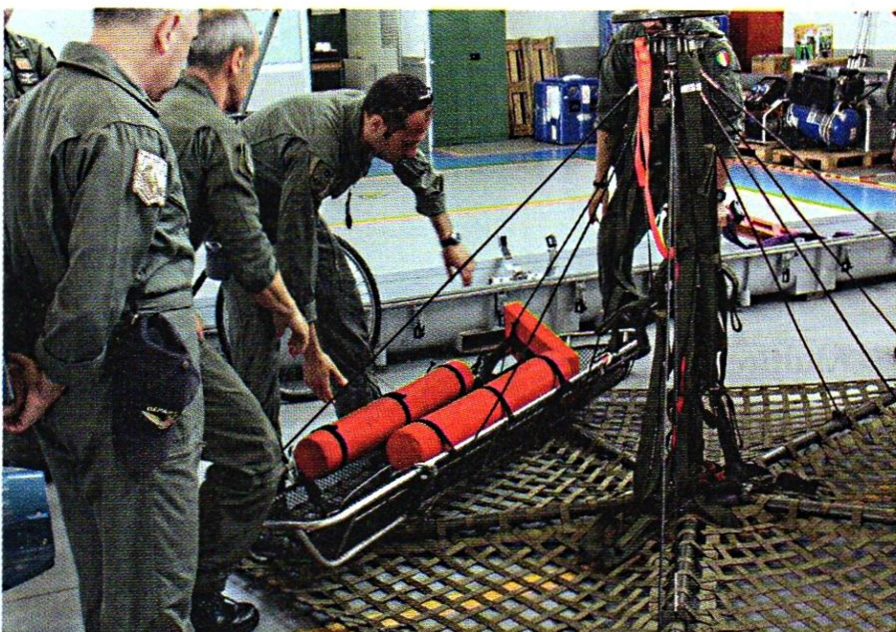
Il sistema Air Tep della Escape International (distribuito in Italia dalla Trade Company) è in grado di infiltrare o esfiltrare 10 uomini contemporaneamente: viene impiegato anche in missioni di soccorso marittimo.
