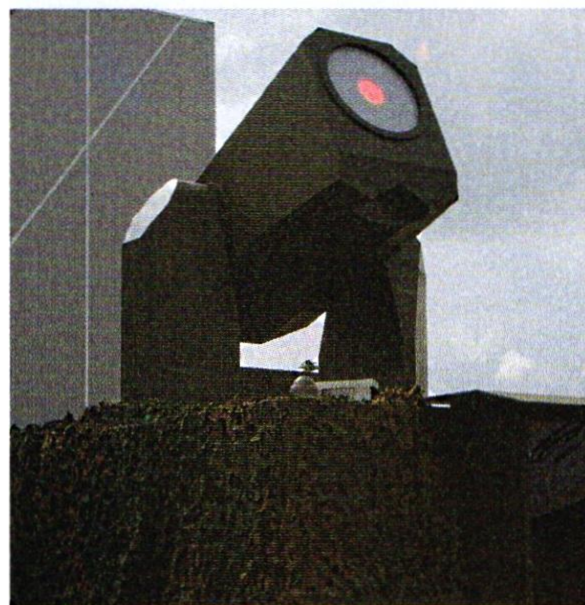
Sopra: il radar multifunzionale tipo AESA (dotato di circuiti al nitruro di gallio) per il sistema PATRIOT presentato dalla Raytheon. Sotto: la nuova arma laser per la difesa contro UAV, razzi e bombe da mortaio mostrata per la prima volta da MBDA. Questo "Laser effector" è installabile su piattaforme terrestri o navali e assicura una copertura su 360° anche contro bersagli multipli.
