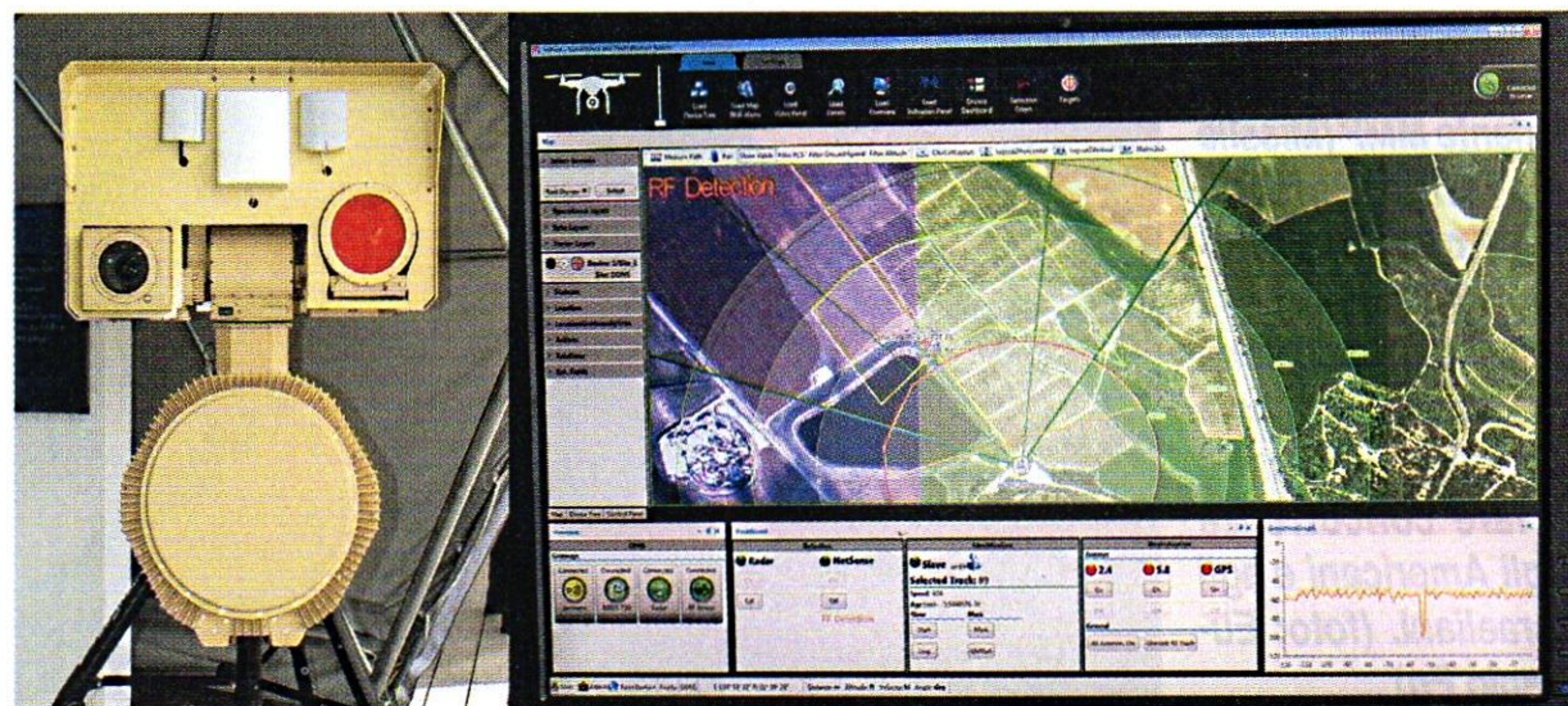
Il sistema DRONE DOME della Rafael (a sinistra il sistema, a destra una tipica schermata sulla console di comando e controllo) è stato pensato per il contrasto ai piccoli "droni". (foto: Paolo Valpolini)
