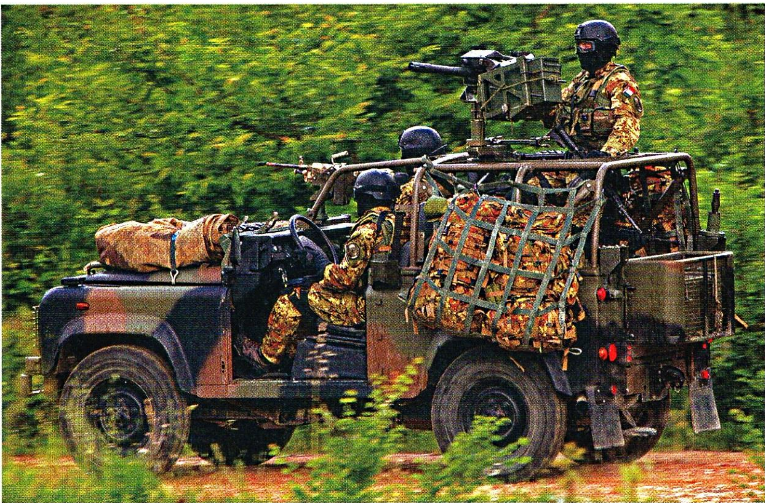
Un VAV-90 (Veicolo d'Attacco Veloce) del IX Reggimento d'Assalto Paracadutisti COL MOSCHIN. Il VAV-90 è in pratica un DEFENDER 90 ST in configurazione simile alla WOLF WMIK.
