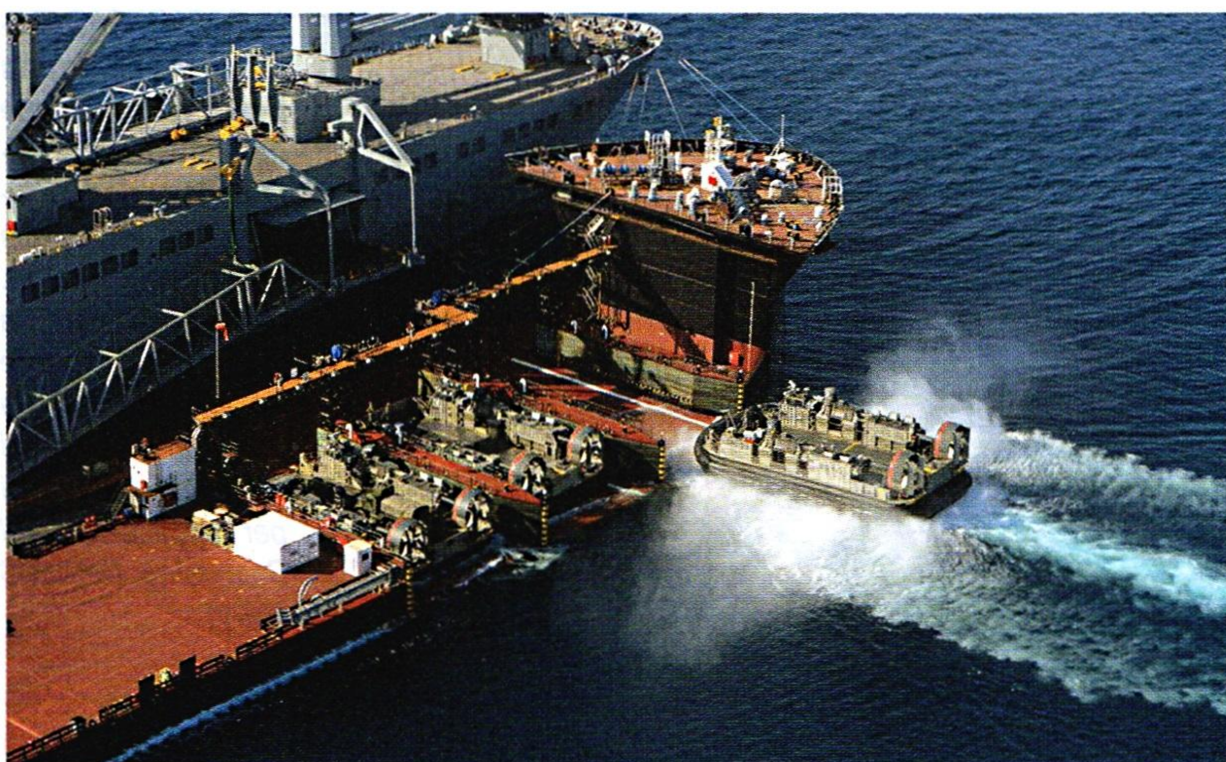
Uno dei 3 mezzi LCAC in manovra nel suo slot di parcheggio: ben visibili la passerella sopraelevata che corre lungo l'area di parcheggio e l'assetto appruato del MONTFORD POINT. (foto: US Navy)
