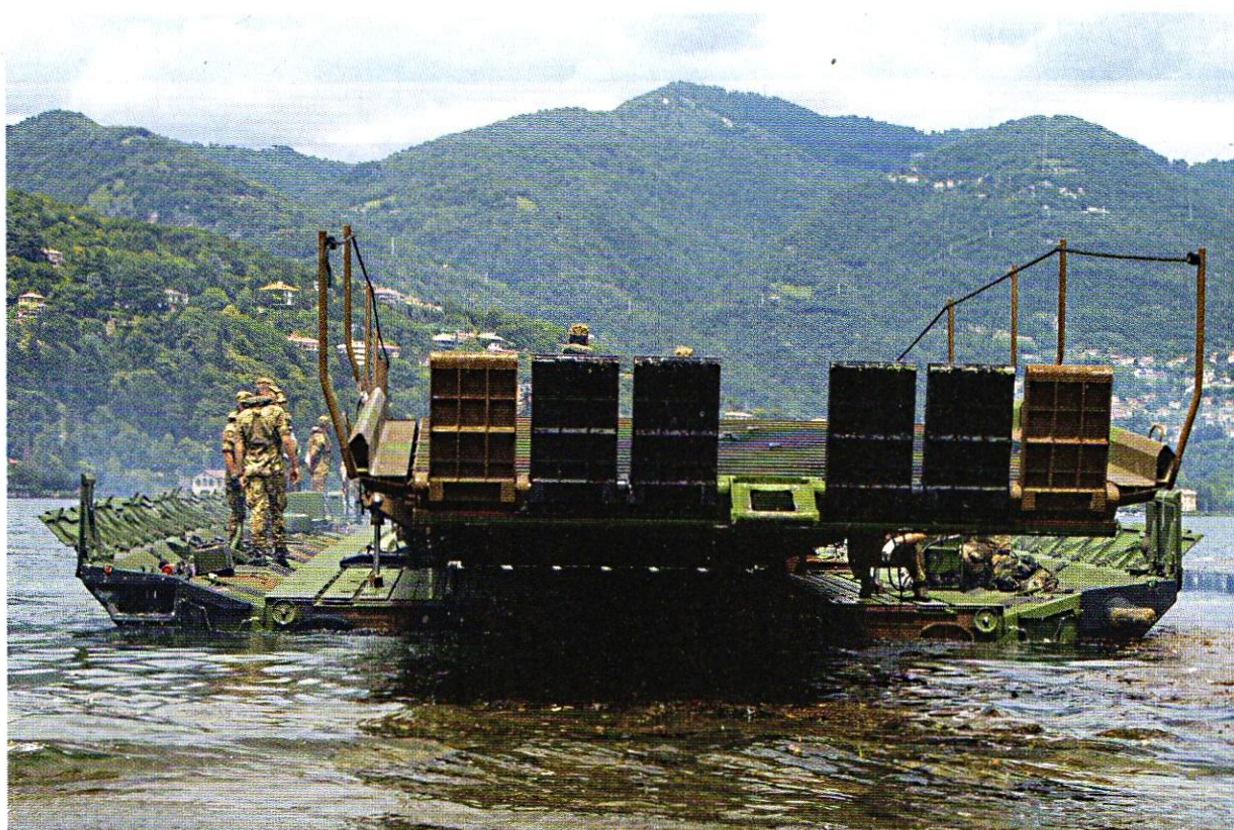
Una portiera formata con elementi del sistema PGM (Ponte Galleggiante Mobile) ripresa sul Lago di Como dove ha simulato il trasferimento di sfollati da una riva all'altra.
