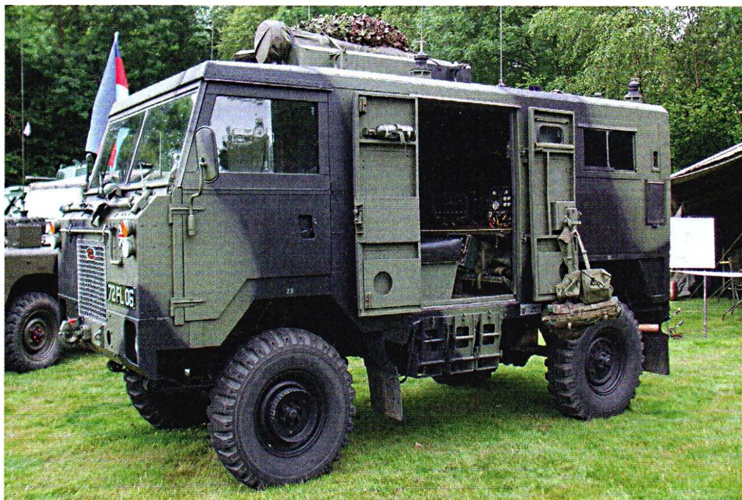
Un 101FC nella variante furgonata utilizzata per ruoli di comando e controllo, veicolo officina, ELINT/ECM. Questo modello si caratterizzò per le eccellenti prestazioni in fuoristrada, grazie all'ottimo gruppo motore/trasmissione, le sospensioni ad ampia escursione e la notevole altezza da terra
