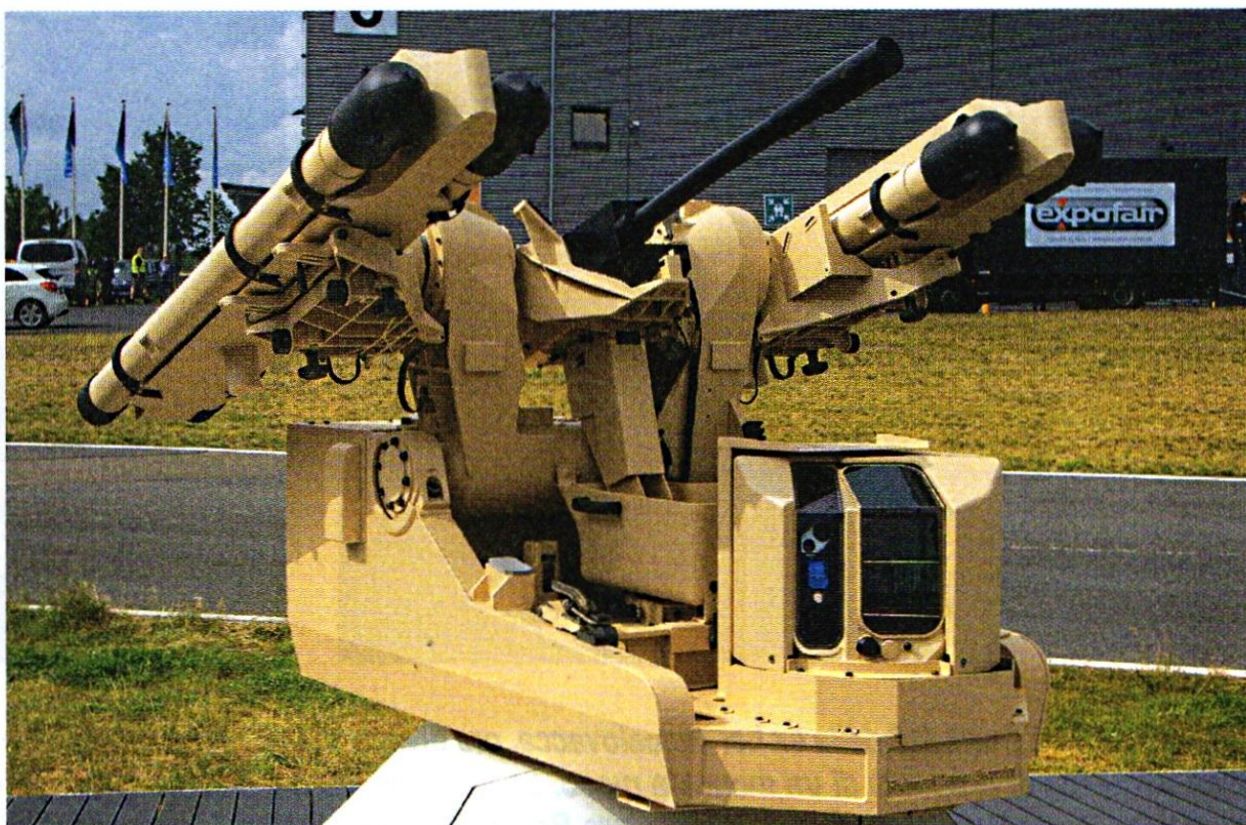
Torretta Rheinmetall MPCS integrabile nel sistema TLVS/MEADS per la difesa a cortissimo raggio, con i 4 missili antiaerei MISTRAL.
