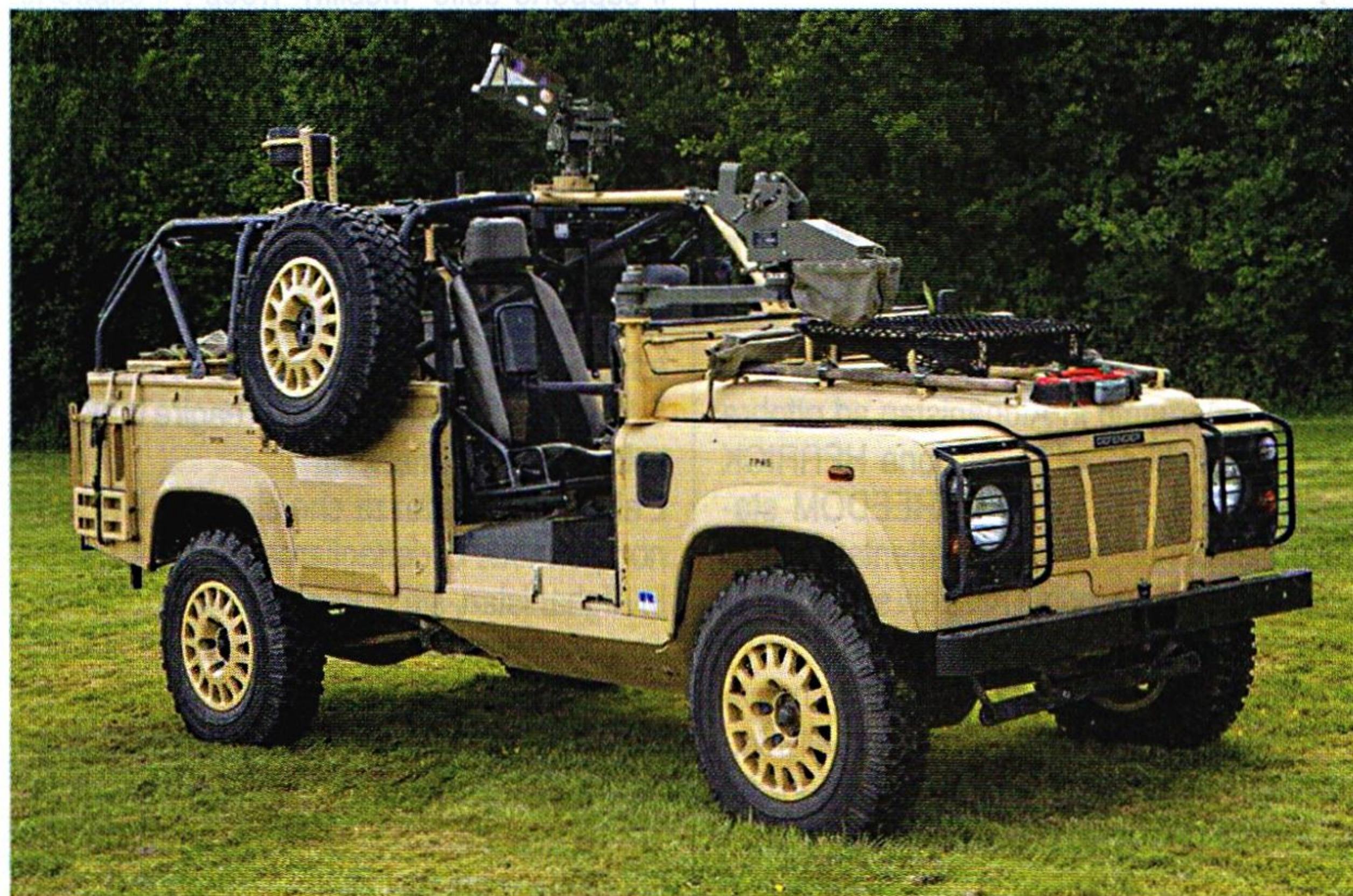
Un esemplare di DEFENDER 110 WMIK, il modello più bellicoso della DEFENDER allestito anche per SAS ed altre forze speciali. Si notino gli affusti modulari predisposti per vari modelli di mitragliatrici e lanciagranate
