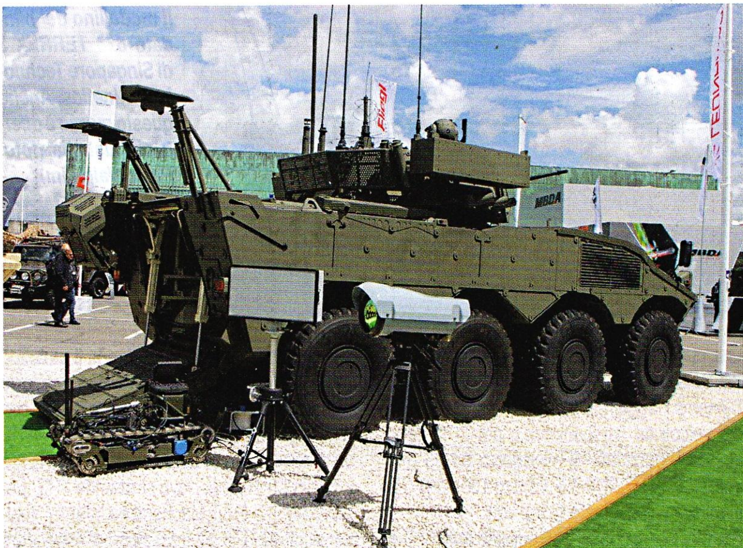
Una vista posteriore del VBM Esplorante nella sua configurazione "dimostrativa" che riunisce in un solo veicolo le dotazioni che nella realtà sono a bordo di 2 distinti mezzi. Si possono notare la camera termica HORIZON, il radar LYRA 10 e l'UGV TRP-2 RISTA Cavalleria (tutti sistemi realizzati da Leonardo). (foto: Eugenio Po)
